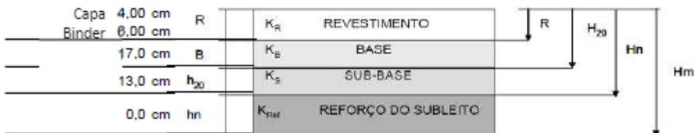
Figura 5 - Dimensionamento da Estrutura do Pavimento
