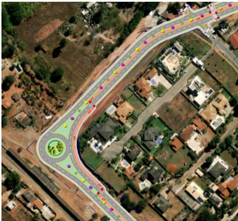
Figura 08 – Vista superior trecho do Segmento B com proposta de implantação de rotatória
