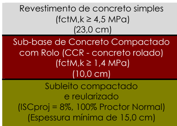
Figura 37 - Estrutura de pavimento rígido adotada - "N" 20 anos - 6,39 \times 10^7 .
