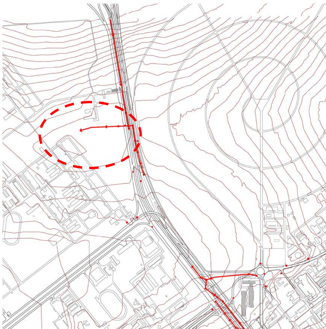
Figura 70 - Rede Ø 1000 mm existente no setor ESPM.
