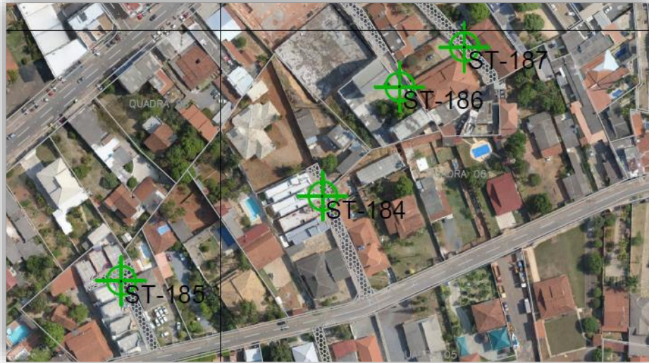
Figura 22 – Sondagens a Trado (Quadra 6 – proximidades da Av. Misericórdia) Fonte: SODF – 2021
