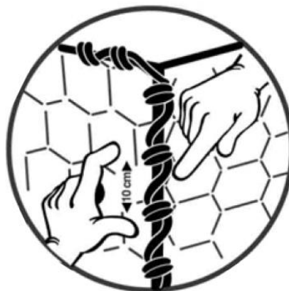
Figura 13: Amarração da malha hexagonal dupla torção.
