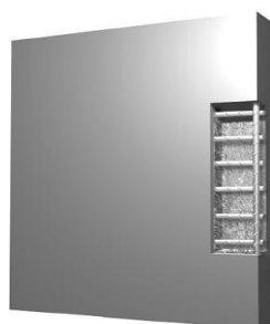
Figura 3 - Vista da peça após tratamento das armaduras
