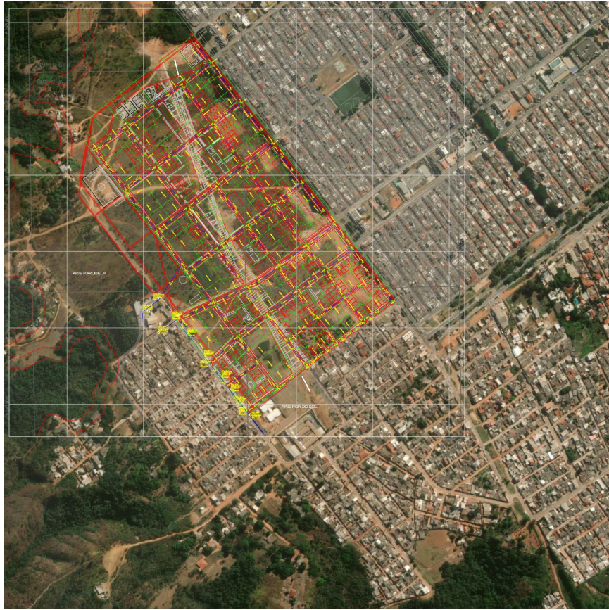
Figura 05 - Área com previsão de ampliação urbana a ser incorporada nos cálculos de contribuição de drenagem Fonte: CODHAB
