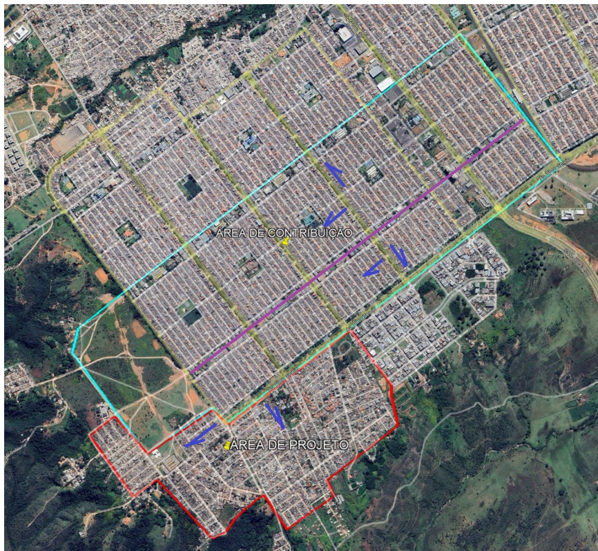
Figura 04 - Áreas das Bacias de Contribuição para dimensionamento da rede de drenagem (vermelho - Área efetiva do Projeto / Azul Claro - Área existente a ser considerada como Contribuição) Fonte: SUPOP/SODF
