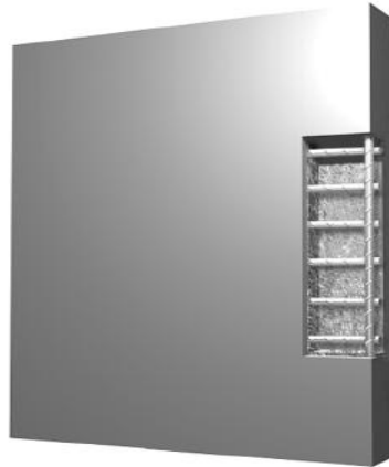
Figura 34 – Vista da peça após tratamento das armaduras
