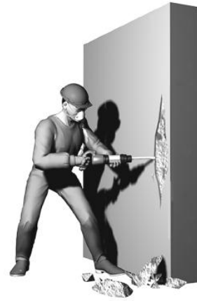
Figura 32 – Delimitação da área de reparo com disco de corte Figura 33 – Demolição superficial do concreto
