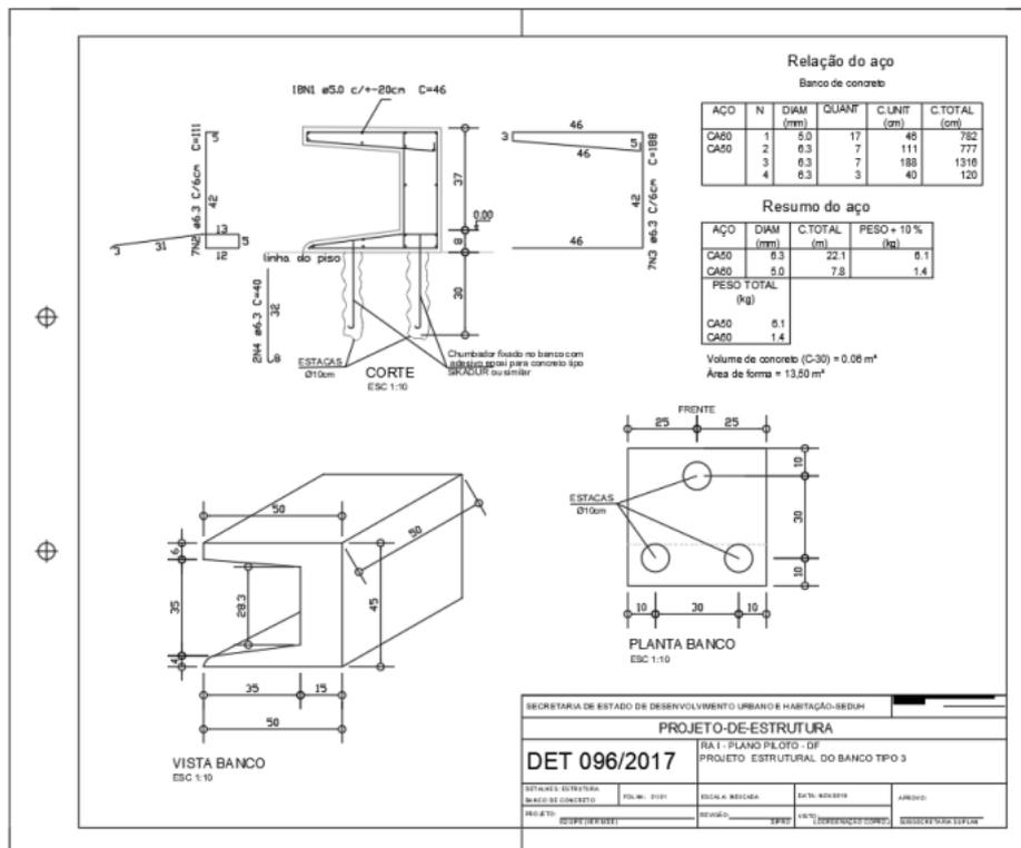
Figura 11 - Detalhe estrutural do banco em concreto
