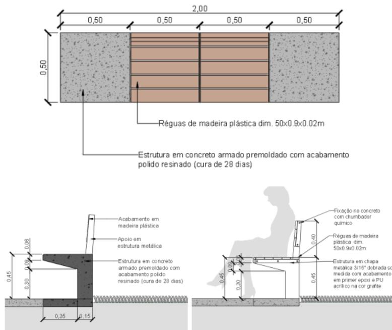
Figura 12 - Detalhe banco modular de concreto e madeira
