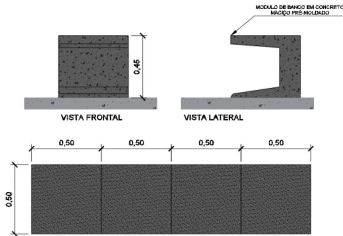
Figura 10 - Detalhe banco em concreto pré-moldado
