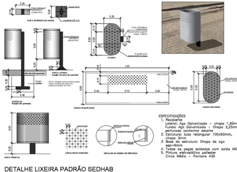
Figura 13 - Detalhe Lixeira Metálica
