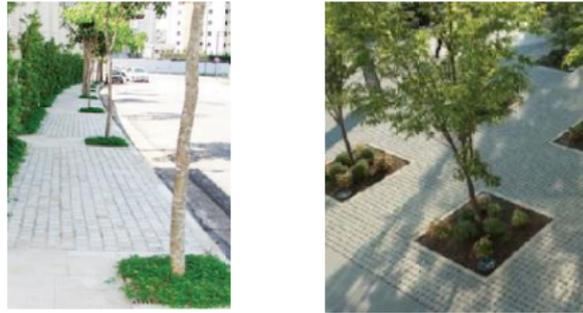
Figura 09 - Detalhe gola de árvore com moldura nivelada com o piso
