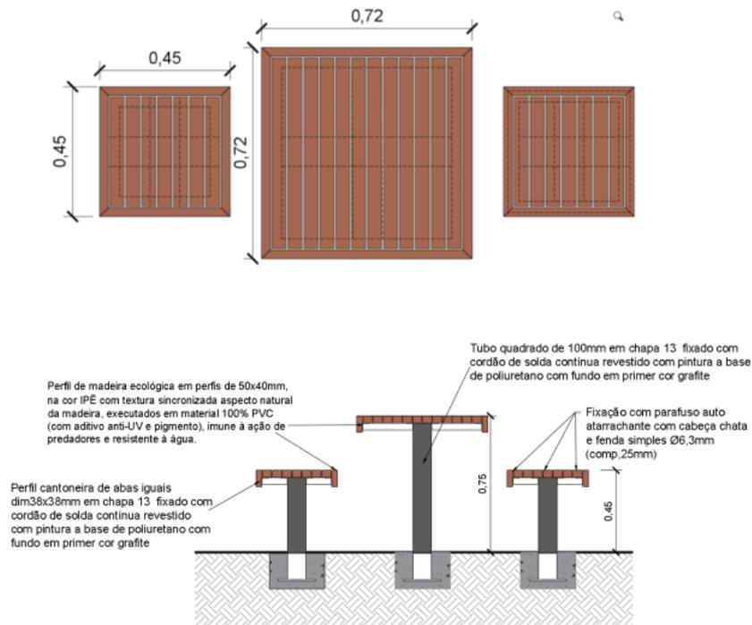
Figura 15 - Detalhe mesa com bancos em madeira ecológica
