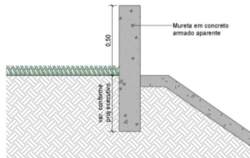
Figura 16 - Representação esquemática do corte da mureta em concreto
