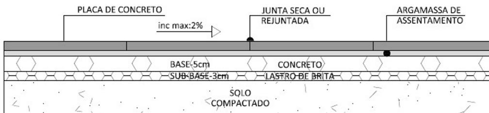
Figura 03 - Detalhe Piso placas de Concreto.
