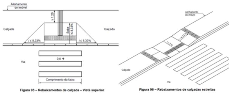
Figura 04 - Detalhe – Rebaixamento de Calçada - Fonte: NBR 9050/2020
