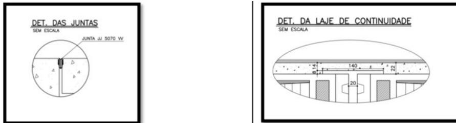
Figura 8 - Junta de Dilatação
