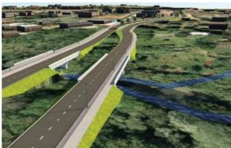
Figura 07 - Perspectiva do Projeto - início da duplicação da Via de Ligação sentido Guará-Núcleo Bandeirante
