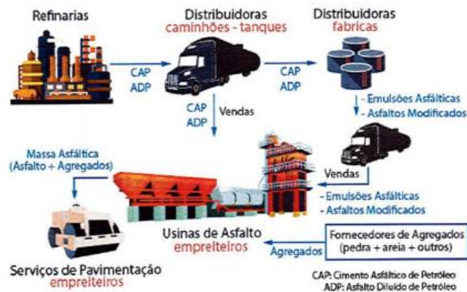
Figura 01 - Cadeia produtiva dos produtos asfálticos (Fonte: ANP)
