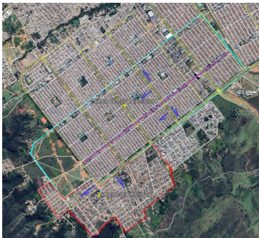
Figura 1 – (Figura 04 do Projeto Básico) - Áreas das Bacias de Contribuição para dimensionamento da rede de drenagem (vermelho - Área efetiva do Projeto / Azul Claro - Área existente a ser considerada como Contribuição) Fonte: SUPOP/SODF
