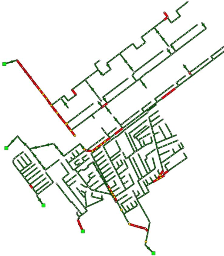
Segundo o Termo de Referência da Novacap (2019), um fator importante a ser observado no projeto de uma rede de drenagem é a velocidade de escoamento do deflúvio, que deve estar entre o limite de 1 m/s a 6 m/s, conforme indicado:
