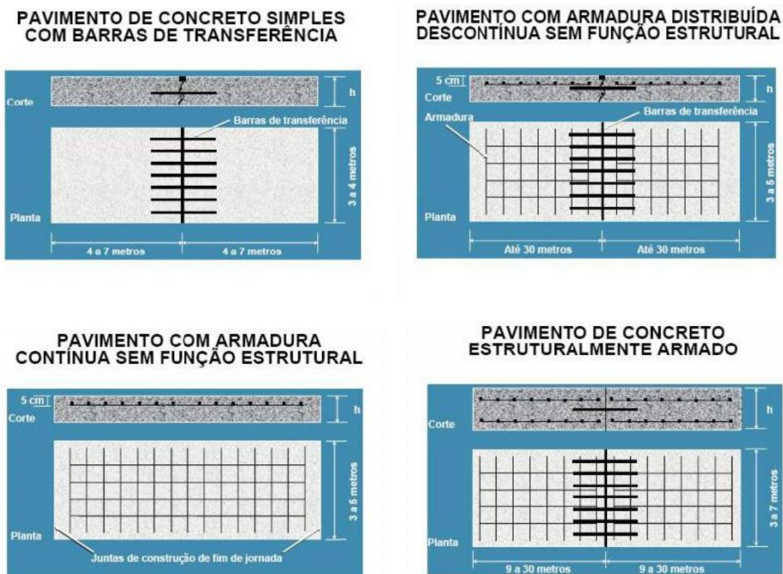
Figura 4.2 - Tipos de pavimento rígido.
