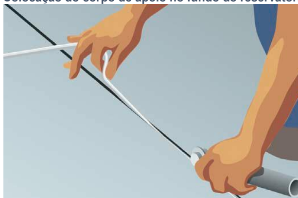
Figura 10 - Colocação do corpo de apoio no fundo do reservatório do selante
